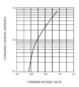
Fig-4 TYPICAL INSTANTANEOUS FORWARD CHARACTERISTIC
